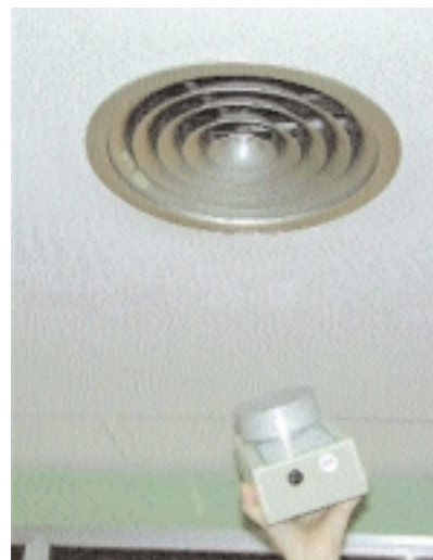
Figura 19.2. Realización de una muestra ambiental a la salida del sistema de ventilación.
